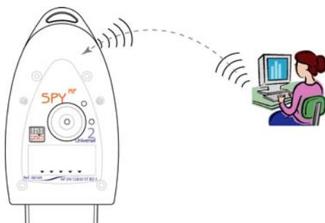
La configuration du SPY RF est réalisée à l'aide du Logiciel Sirius puis transmise au SPY RF par radio fréquence.
